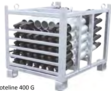
Tankoteline 400 G työntötangot Ø 54 mm, tehollinen pituus 700 mm, sisältö: 49 tankoa tai työntötangot Ø 35 mm, tehollinen pituus 700 mm, yhdessä tankotelineessä 107 tankoa
