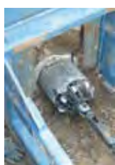
Rulla-avennin muotoilee putken uudelleen
