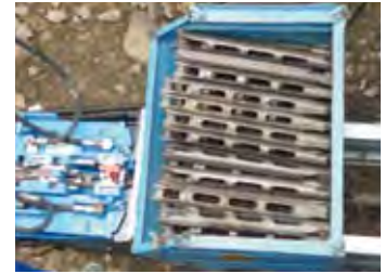
Tankoteline 400 S työntötangoille: Ø 54 mm, tehollinen pituus 470 mm tai tangoille Ø 35 mm, tehollinen pituus 700 mm telineessä 107 tankoa.
