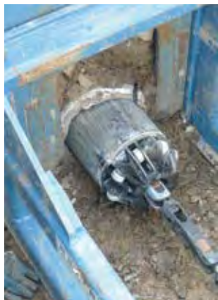
Ohjausrullilla varustettu rulla-avennin tasoittaa kaikki epämuodostumat
