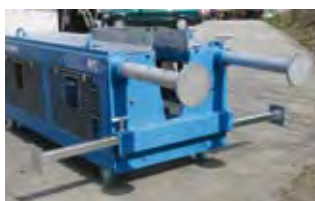
Tankoteline 1250G tangoille Ø 100 mm, tehollinen pituus 1700 mm, sisältää 34 tankoa
